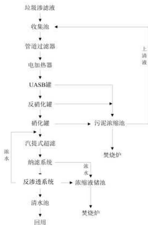
图 2.2-12 一期污水处理站工艺流程图
